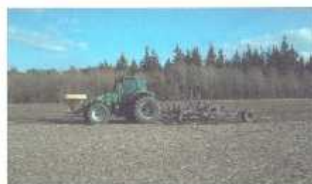
Stubharven er med basis i en Agroden ammoniakneafelder, og den kan holde bearbejdningen nede på blot fire centimeter.
